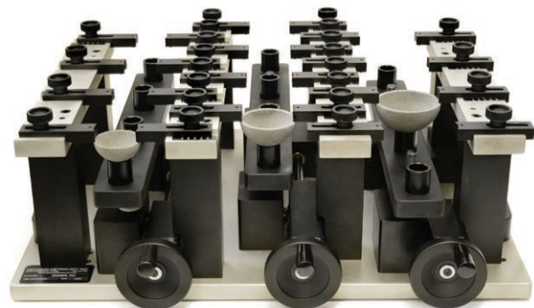
Bridage sur mesure servant à tenir simultanément une gamme de pièces de tailles diverses.
