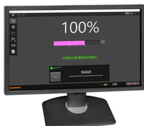
VIONiC エンコーダシステムには、Advanced Diagnostic Tool ADTi-100 とソフトウェア ADT View を使用することができます。エンコーダからリアルタイムでさまざまなデータを取得して、難しい取付けや診断に役立ちます。ソフトウェアのインターフェースは直感的な作りになっており、下記の機能が使用できます。
