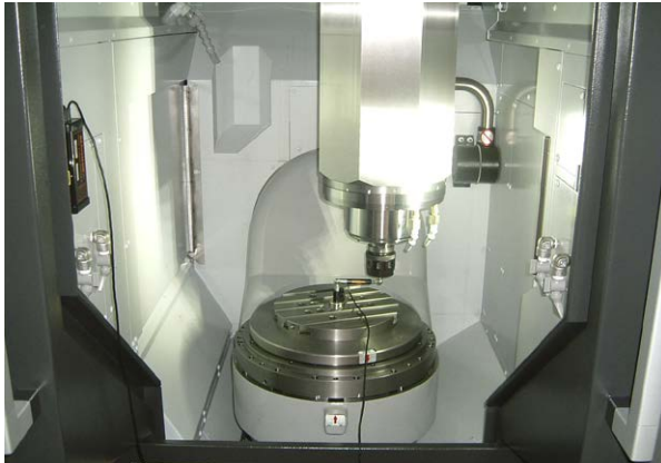
NMV 立形ターニングセンターでの QC10 ボールバーテスト
