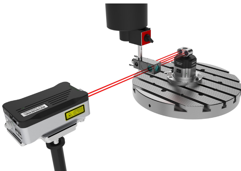
図1 XL-80 を参照レーザーとして使用した回転軸キャリブレーションの一般的なセットアップ
