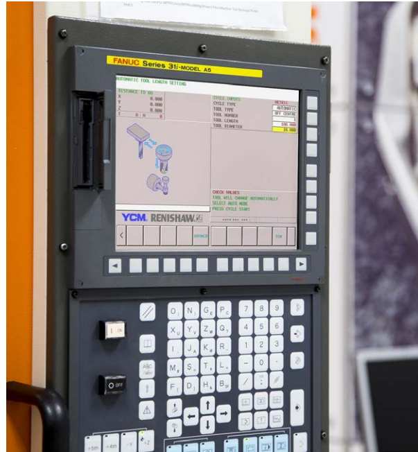
ファナック製コントローラに搭載されたレニショー製 GUI
