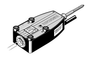
RLD 0°ヘッドは、平面鏡干渉計 (PMI) と反射鏡干渉計 (RRI) のそれぞれを組み込んだ2種類のバージョンをご利用いただけます。 光ファイバーケーブルをディテクターヘッドから、また電気信号ケーブルをレーザーユニットからそれぞれ外すことができるため、各ケーブルを小型のケーブルトラックやダクトを通して配線できるようになっています。 ディテクターヘッドには安全にご使用頂く為のインターロックが組み込まれており、ファイバまたは電気ケーブルが外れているときには、レーザー光線が照射されないようになっています。
